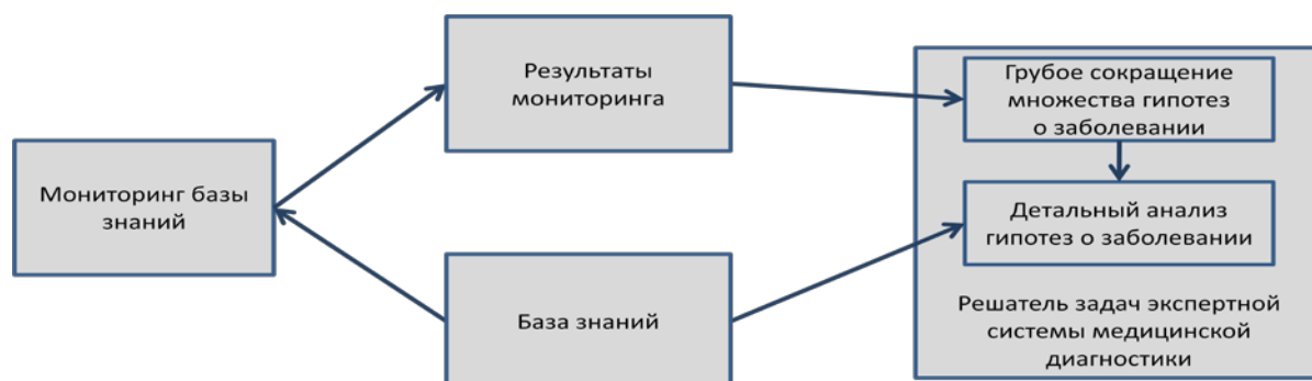
Рис. 6 Автоматическое управление решателем задач экспертной системы медицинской диагностики
